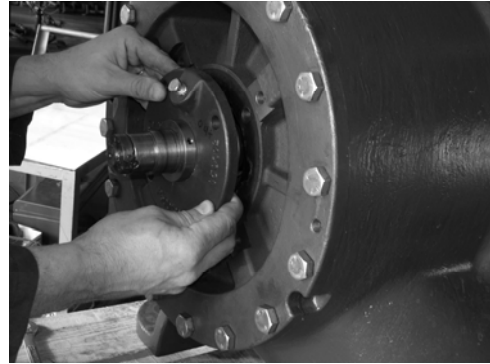
图 28: 移除填料函盖组装体和轴套
