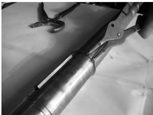
图 36：安装叶轮扣环
