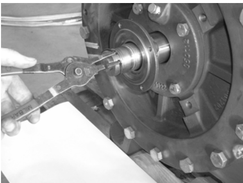
图 27: 移除轴承备用环(只用于 2"框架)
