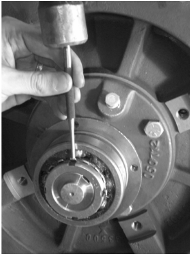
图 50：安装锁紧垫圈和锁紧螺母
