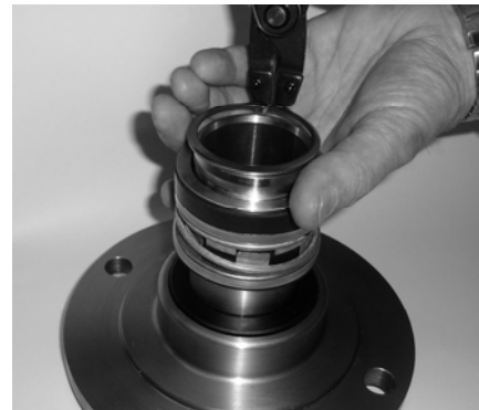
图 29: 移除了扣环的机械密封头和填料函盖
