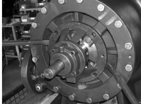
图 24：使用撬杆移除内侧轴承支架
