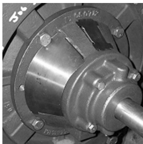
图 21: 安装到内侧轴承支架的支架保护装置
