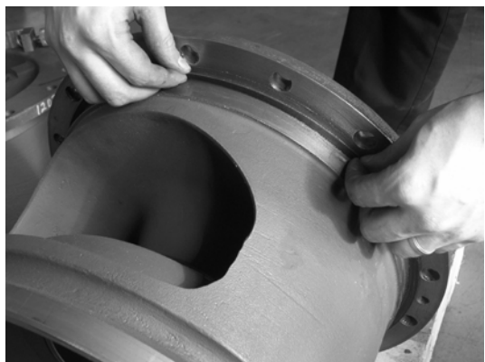
图 38：将衬垫安装到盖板
