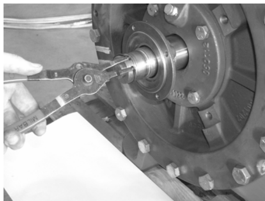
图 49：安装轴承备用环（只针对 2" (50.8mm) 框架的泵）
